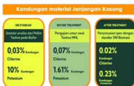
Kenapa diturunkan agar pipa pada tungku bakar tidak mengalami proses korosi sehingga aman digunakan dan juga dengan adanya penurunan parameter tersebut nilai kalori nya meningkat. Saat ini sedang dilakukan pengkajian dengan skala *workshop* (2ton/day) dan menguji validasi flow proses mesin sehingga siap untuk skala
